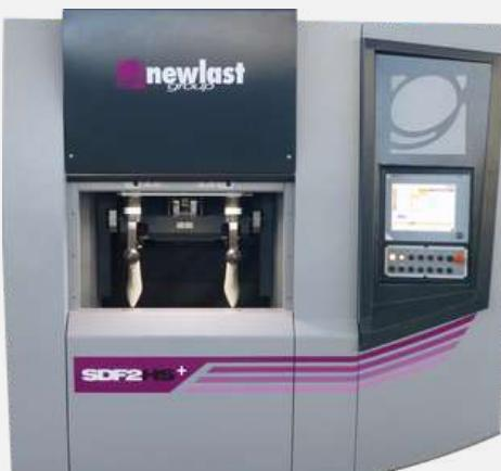
SDF2HS+ è la finitrice a un paio di ultima generazione. Il sistema di presa a "coda di rondine" sulla cresta della forma, ne consente la lavorazione completa in macchina, anche nella punta e nel tallone, ed elimina tutti i rischi di deformazione del modello dovuti alla pressione di bloccaggio delle contropunte e alla loro rimozione manuale.
