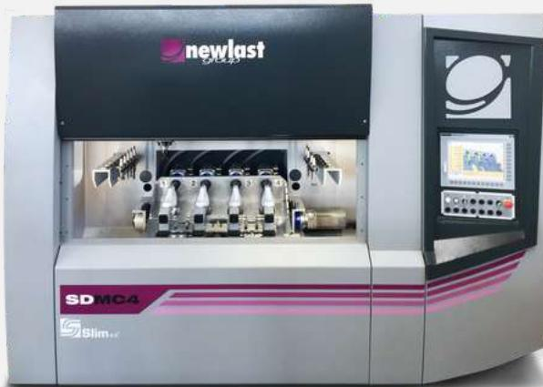
SDMC4 è un centro di lavoro a 8 assi concepito per effettuare speciali cicli di foratura e fresatura su forme. Gli assi X, Y e Z muovono l'elettromandrino mentre le forme basculano e ruotano su se stesse. La produzione viene effettuata su 2 paia di forme sgrossate (ed eventualmente snodate), il bloccaggio avviene mediante i supporti su punta e tallone, ogni ciclo viene eseguito su una forma alla volta. La macchina è dotata di un Magazzino di 10 utensili.
