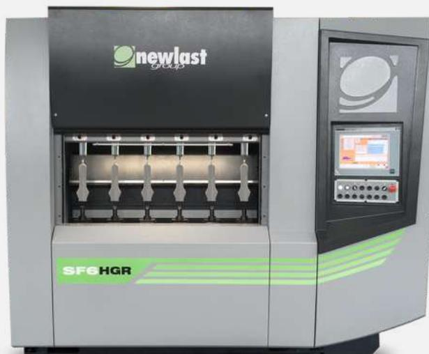
SF6 HGR permette di produrre appendiabiti in legno di varia tipologia partendo da un blocchetto di legno singolo o sdoppiato, posizionandolo in ognuna delle 6 stazioni presenti in macchina.
